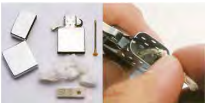
ウィックの交換は、まず、中の綿をすべて出してから、写真のように上からウィックを差し込む。
